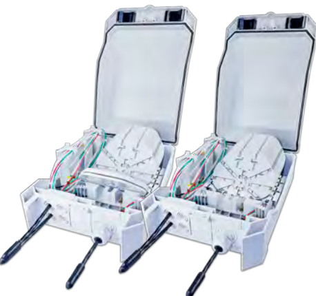
Große IP55 Box ohne Spleisskassetten. Möglichkeit zum Einbau von verschiedenen Spleissmodulen. Max. 3 Module. Aufnahme für Überlänge der Bündeladern bereits im Lieferumfang enthalten. Für bis zu 288 Fasern Standardauslieferung ohne Kabeleinführung
