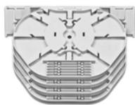
Spleissmodul mit 4 Spleisskassetten für Schrumpfspleisschutz. Pro Kassette max. 12 Spleissungen. Ablage des Spleisschutz in 2 Lagen zu je 6 Stück. Gesamtanzahl Spleissungen: 48
