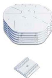
Spleissmodul mit 4 Spleisskassetten für Schrumpfspleisschutz. Pro Kasette max. 12 Spleissungen. Ablage des Spleisschutz in 2 Lagen zu je 6 Stück. Gesamtanzahl Spleissungen: 48
